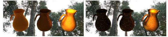
Figura 6: Izquierda: el muestreo uniforme empleando 1,970 segundos tiene un 36,81 % de error. Derecha: muestreo basado en el lóbulo coseno en S^2 . El tiempo de muestreo es 15,200 segundos y el error relativo 20,86 %.
