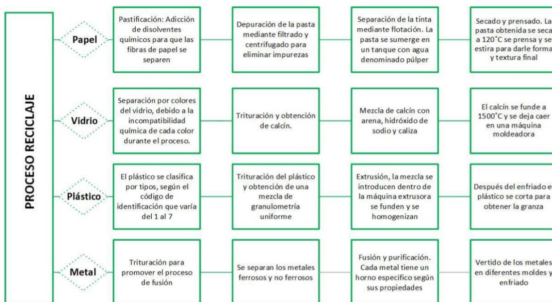
Fig.19 Proceso de reciclaje de diferentes materiales. Original de [37].
