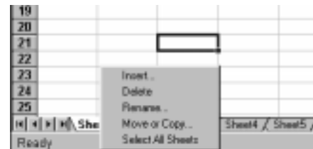
Figura 10. Menú contextual para trabajar con las distintas hojas de cálculo de un libro de trabajo.
